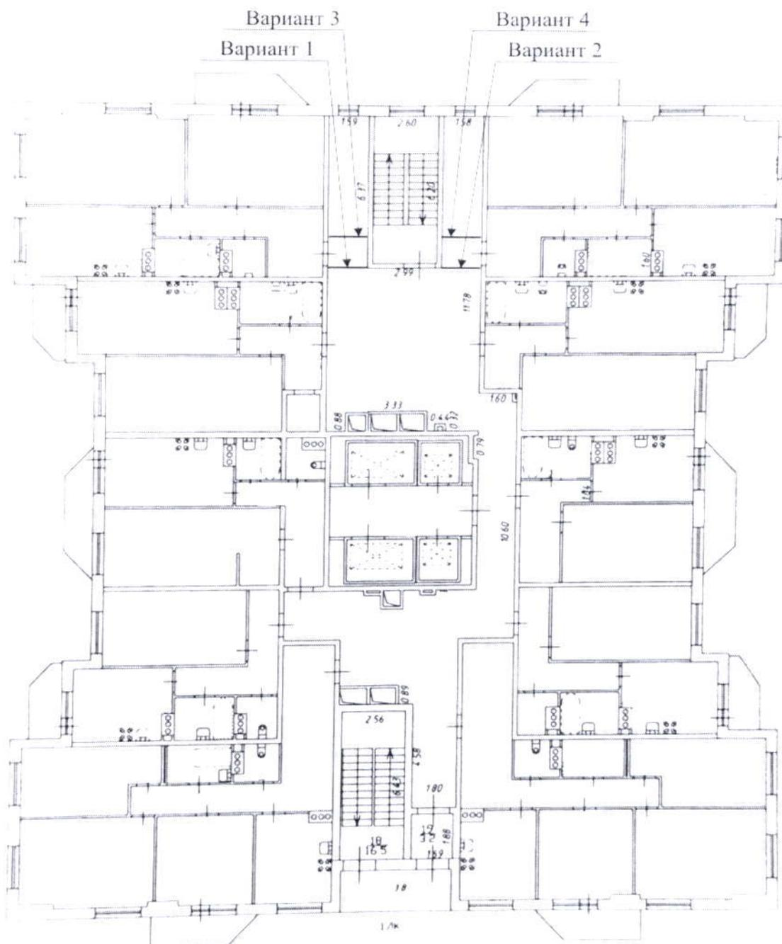
Варианты установки перегородки(конструкции). Для Вариантов 3 и 4 возможно смещение перегородок в сторону окна. Вариант 1 и 2 не должен выступать за габарит стены с дверью теплой лестницы.
